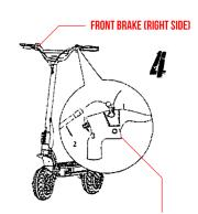
INSERT THE BRAKE CABLE INTO THE HANDLEBAR. TURN THE FIXATOR SO THAT THE CABLE DOES NOT FALL TEST AND MAKE THROUGHLY SURE BOTH BRAKES ΛRE FUNCTIONING.
